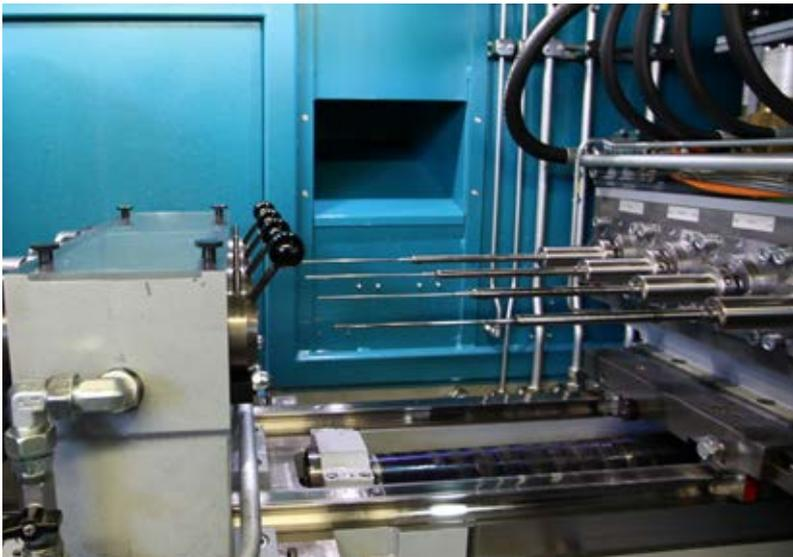
Traub TBT 250 mit bis zu vier Bohrspindeln
